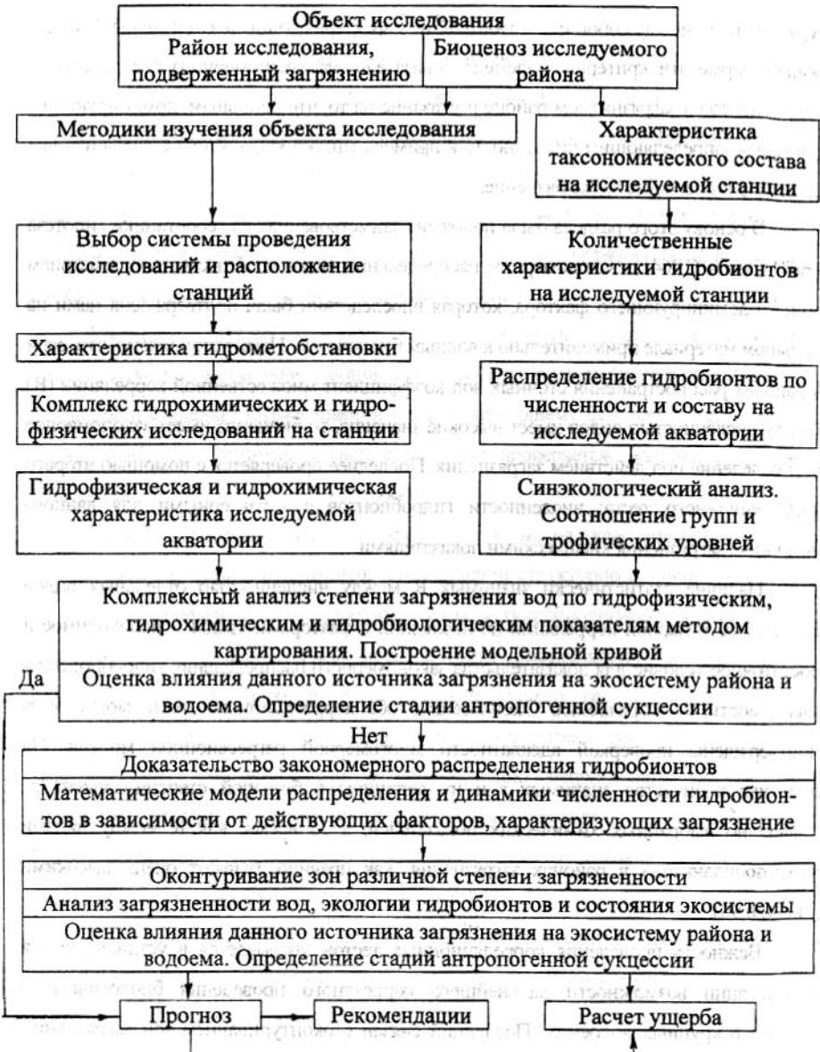
Рис.2. Структурный разрез системы БАЗВ, раскрывающий основные этапы оценки степени загрязнения вод в крупных водоемах
